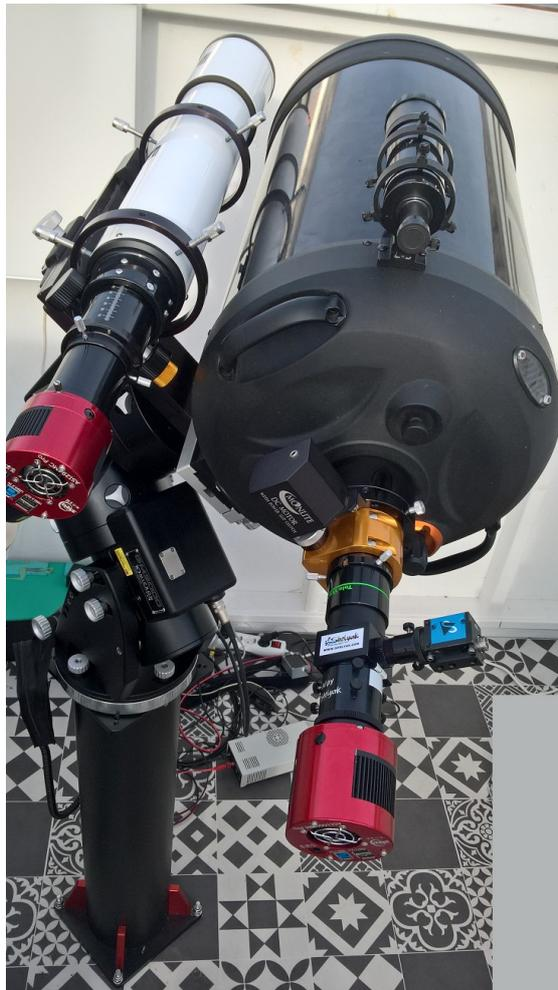
Pour mesurer la vitesse radiale moyenne, nous avons obtenus les spectres de 20 galaxies (Messier 58, 59, 60, 84, 85, 86, 87, 88, 89, 90, 91, 98, 99, 100, NGC4216, 4394, 4438, 4450, 4459, 4473) avec un Schmidt-Cassegrain de 355 mm opérant à f/7, un spectroscopie Alpy600 et une caméra ASI 1600MM en bining 2.
